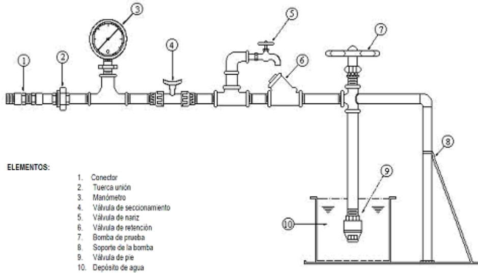
**6.2.5 Procedimiento.****6.2.5.1 Prueba de abrazadera/silleta y válvula de inserción (Figura 2)**
