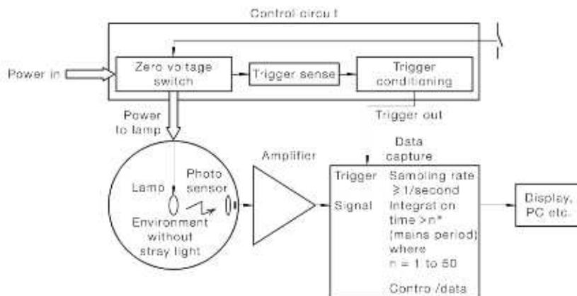
**FIGURE C1 – TYPICAL SET-UP FOR RUN-UP TIME TEST**
