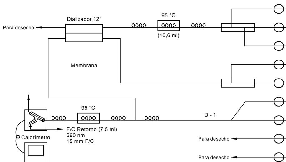
**Figura 3. Autoanalizador usado en la determinación de fosfatos"**
