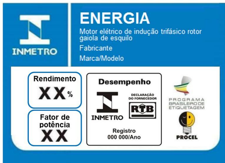
Figura 2 – Modelo para motores menores.
