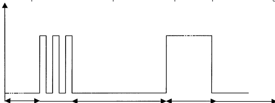
Figura A.2 - Secuencia de prueba recomendada para cada temperatura de prueba para las pruebas de retorno de cero (DR) y creep cuando se realizan en una máquina diferente de aquella utilizada para las pruebas de carga.
