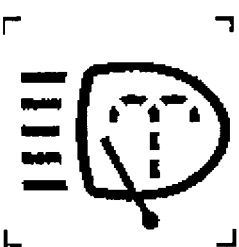
Figura 14 Dispositivo limpiafaros (con mando de funcionamiento independiente) ISO 2575 n° 4.19
