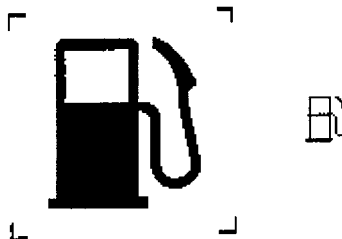
Figura 21 Nivel de combustible ISO 2575 nº 4.14 Color de la luz testigo: amarillo
