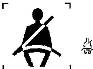
Figura 9 Cinturón de seguridad ISO 2575 n° 4.18 Color de la luz testigo: rojo
